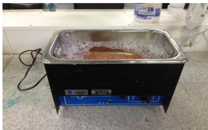
Figura 6. Limpeza dos corpos de prova, em ultrassom, após o procedimento de acabamento.
