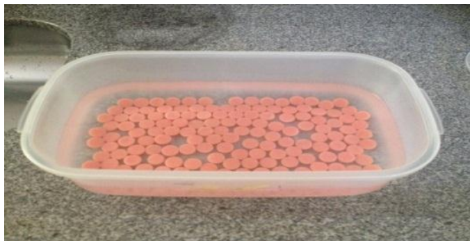
Figura 7. Os corpos de prova foram mantidos em água destilada, por pelo menos 48 h antes do início dos testes, para eliminação do monômero residual.
