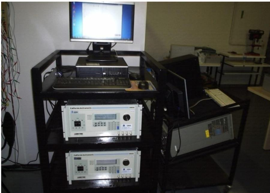
Fig. 13. Fonte programável responsável por aplicar a sobretensão.
