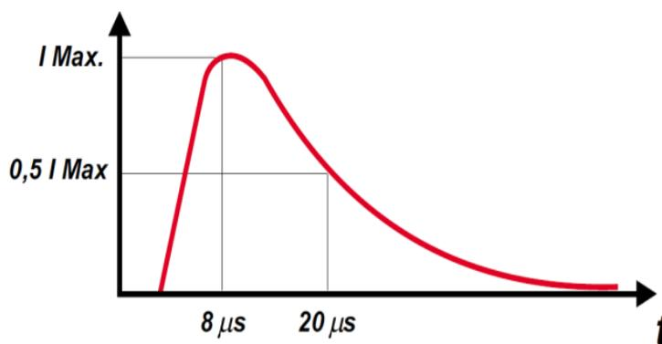
Fig. 32. Forma de onda padrão para o impulso de corrente.
