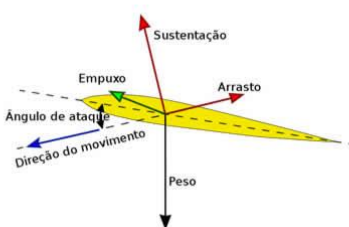
Figura 7– Forças presentes na asa em movimento. Fonte: BASTOS, 2011.
