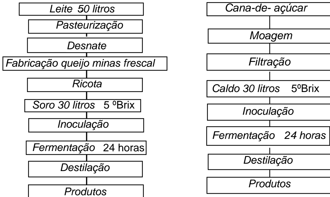
Figura 1: Fluxograma de preparo e obtenção de aguardente de soro de leite e cana-de-açúcar
