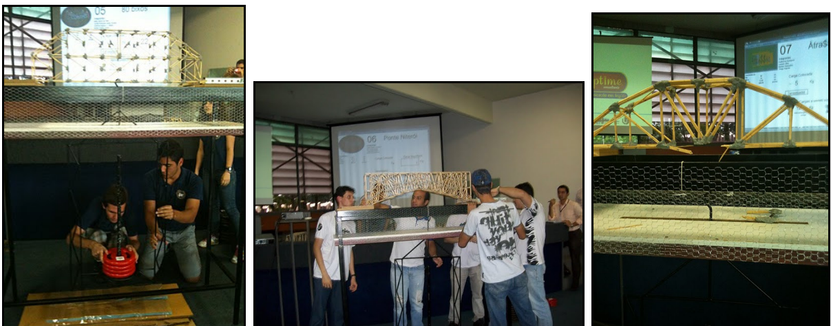
Figura 5 - Realização do teste de carga do I COMPET.
