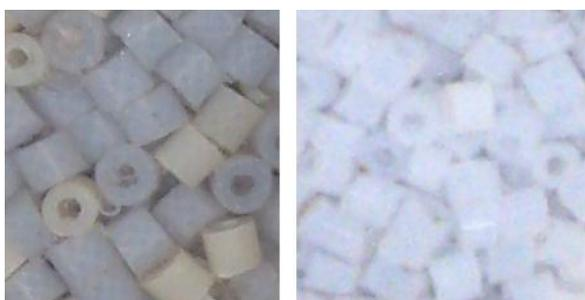
Figura 4 – Recheio dos reatores aeróbio e anaeróbico respectivamente.
