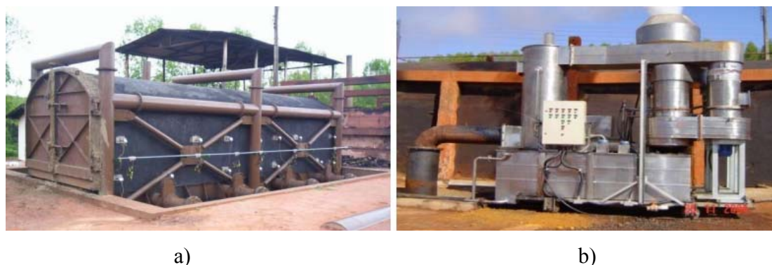
Figura 2.5 - Adaptações em fornos retangulares de alvenaria (RAAD, COSTA E WINTER, 2008): a) Instalação de termopares; b) Uso de gaseificadores.
