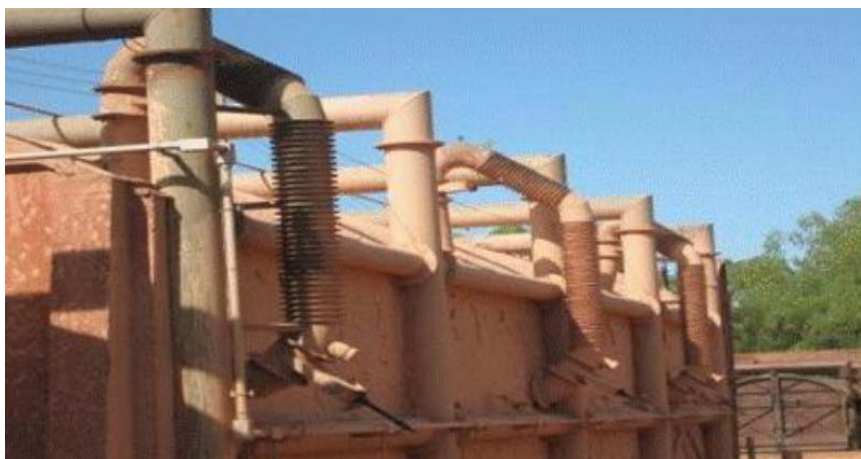
Figura 6.1 – Forno de Alvenaria com recirculadores aletados.(RAAD , 2008)
