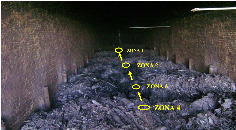
Figura 3.4 – Pilhas de carvão no interior do forno RAC 220 (Oliveira, 2009)
