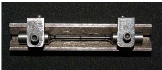
Figura 5: Dispositivo para padronização da posição da soldagem
