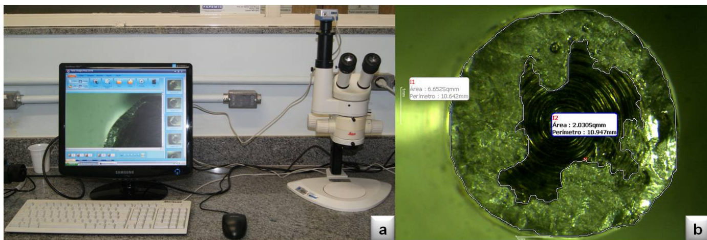
Figura 9: a) Lupa Estereoscópica; b) Exemplo de imagem gerada pela lupa estereoscópica e de como foram realizadas as medidas da área de penetração no software.
