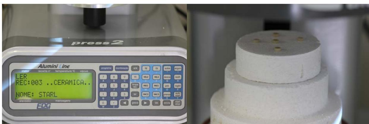
**Figura 4.** Forno para sinterização de porcelana feldspática Alumina press2, corpos de prova posicionados para queima.
