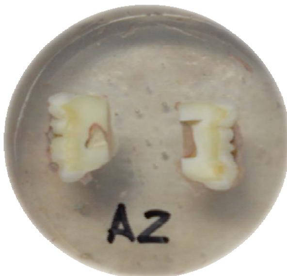
**Figura 2 - Amostras seccionadas e incluídas em resina de poliestireno.**
