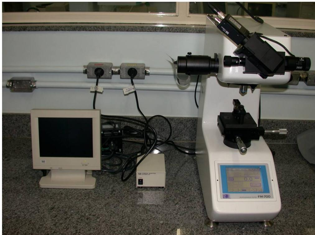
**Figura 6 - Máquina de ensaio de dureza.**
