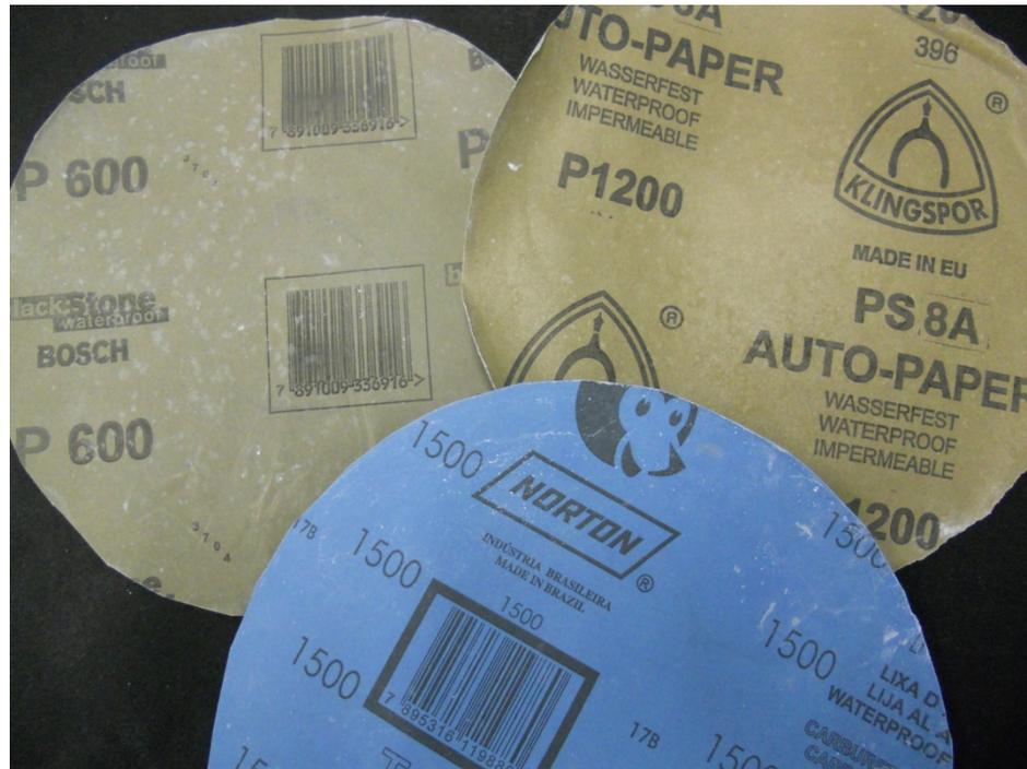
**Figura 4 - Lixas de diferentes granulações.**
