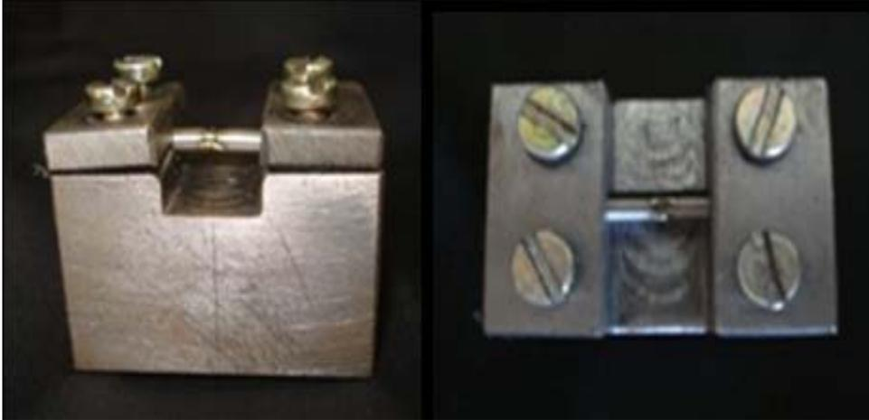
**Figura 04:** Dispositivo de fixação das barras para soldagem.
