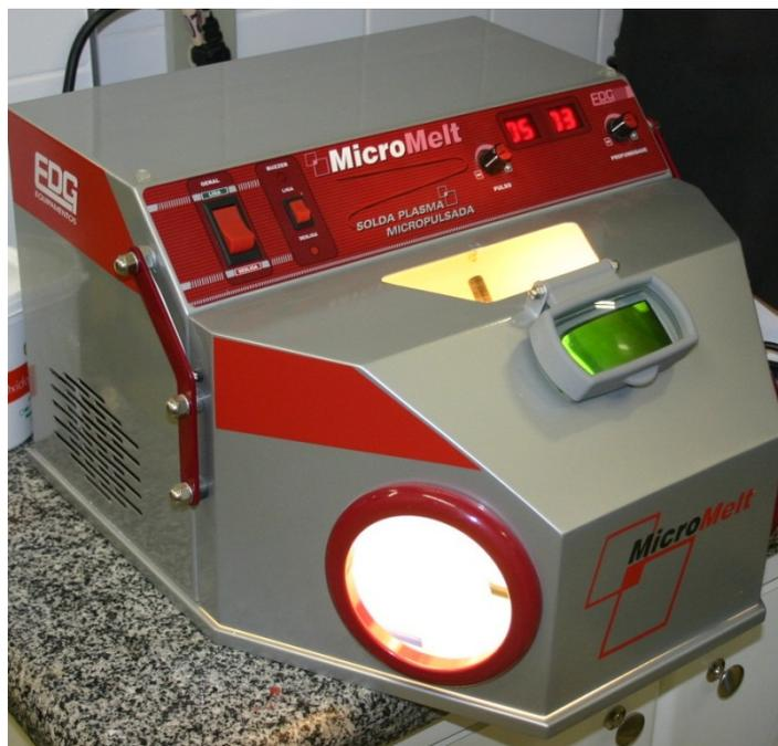
**Figura 03:** Máquina de solda Plasma Micromelt.
