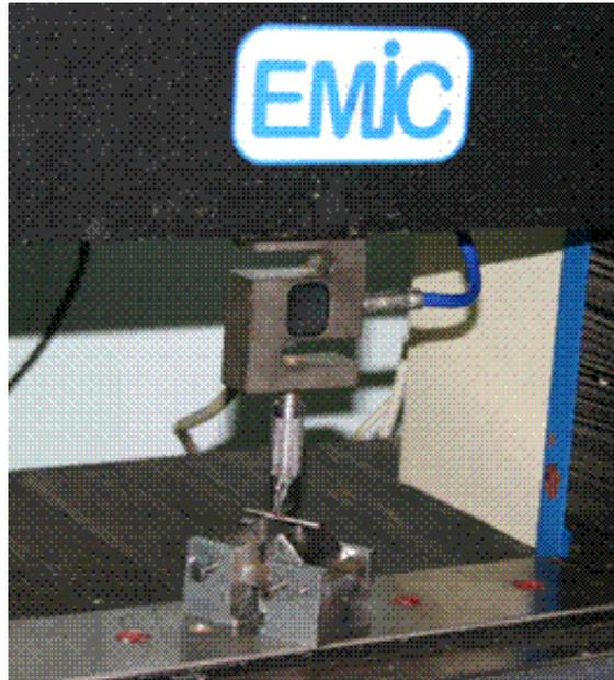
**Figura 07:** Posicionamento da mesa e da ponta aplicadora de força na EMIC.
