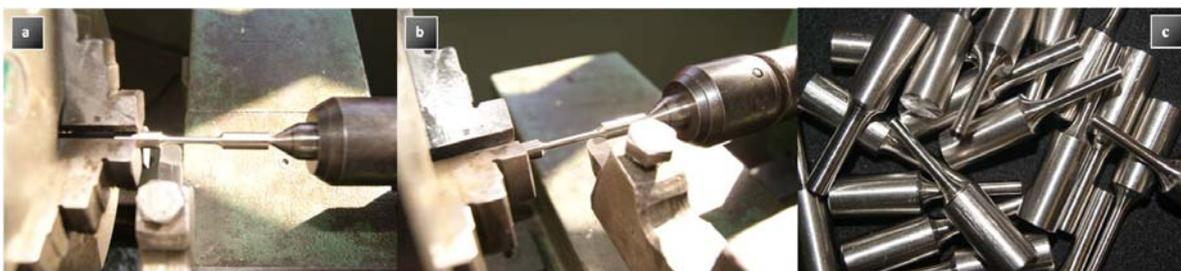
Figura 2: a e b) Usinagem dos corpos de prova; c) Metades dos corpos de prova.
