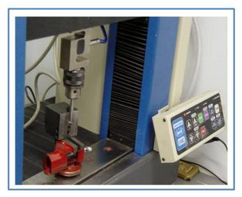
Figura 10. Conjunto pilar/implante submetido a carregamento de flexão.
