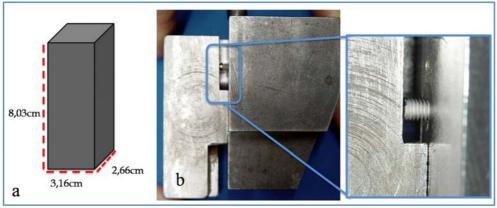
**Figura 7.** Estativa para padronização do posicionamento dos implantes com corpo exposto de 4mm até plataforma e comprimento nominal na altura da estativa..
