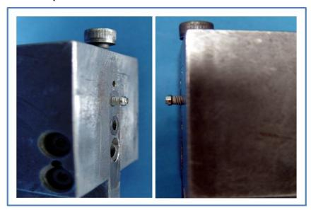
Figura 6. Posicionamento dos implantes, com corpo exposto de 4,0mm até plataforma.
