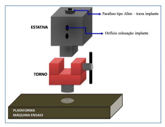
**Figura 5.** Desenho esquemático mostrando padronização na fixação da estativa à máquina de ensaio mecânico.
