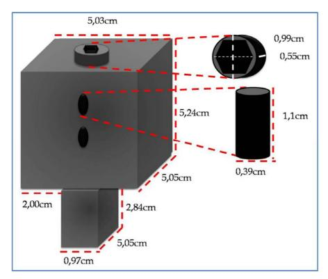
Figura 3. Desenho esquemático mostrando medidas estativa.
