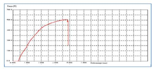
**Figura 11.** Gráfico gerado pelo programa (TESC, EMIC) na forma de curva de força (N) x deslocamento (mm).
