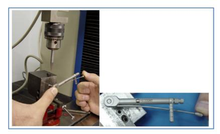
**Figura 9.** Aplicação de torque aos parafusos dos pilares segundo instruções do fabricante.
