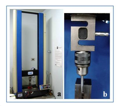
**Figura 8.** (a) máquina de ensaio mecânico (EMIC, 2000DL São José dos Pinhais, Brasil), (b) célula de carga de 500KN e ponta aplicadora acoplada.
