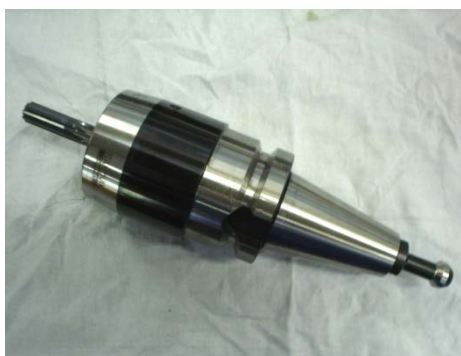
Figura 1: Mandril hidráulico usado nos ensaios de alargamento
