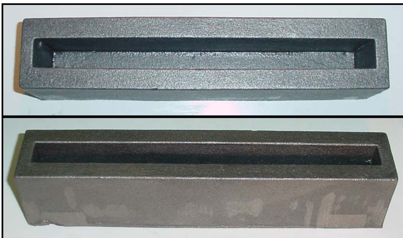
Figura 2: Vista Corpos de prova de ferro fundido vermicular
