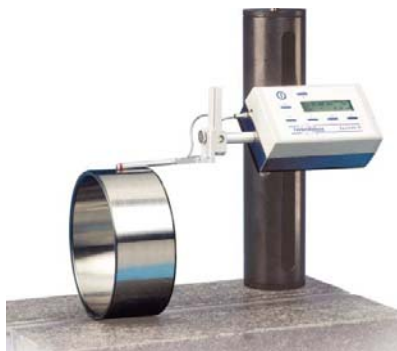
Figura 8: Rugosímetro Surtronic 3+ da Taylor Hobson
