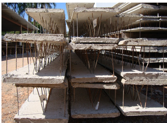
Figura 7 – Painel duplo treliçado fabricado pela Premom Indústria de Pré-Fabricados.
