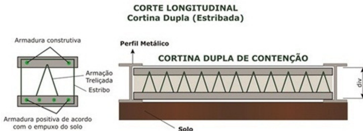
Figura 27 – Armaduras utilizadas no painel duplo em muros de contenção.
