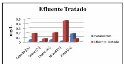
Figura 4. Gráfico com valores obtidos da amostra de efluente tratado e valores de referência CONAMA-357/05
