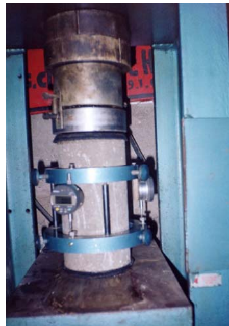
Figura 5: Execução do ensaio do módulo de deformação
