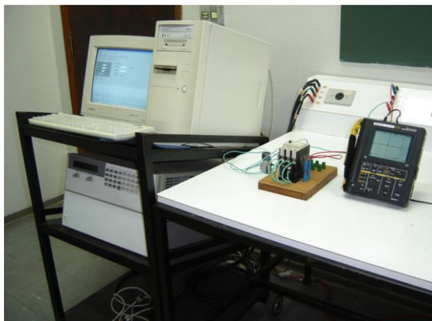
FIGURA 2 - Montagem dos ensaios de laboratório para análise de desempenho do contator ca.
