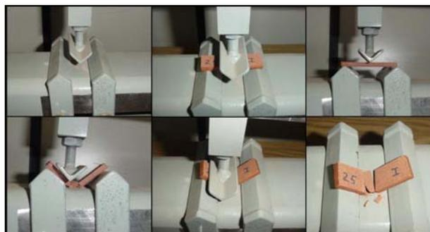
Figura 3. Detalhe da ruptura à flexão dos CP's
