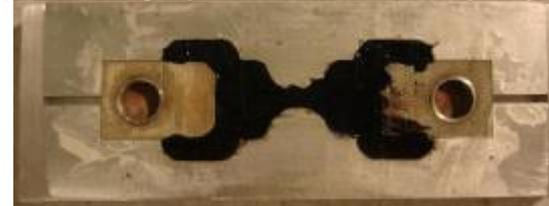
Em seguida os corpos de prova, ainda nos moldes, devem ser colocados na estufa a temperatura controlada, dentro da prensa universal. Esse conjunto deve permanecer na temperatura de ensaio durante, no mínimo, 4 horas para estabilização da temperatura.
