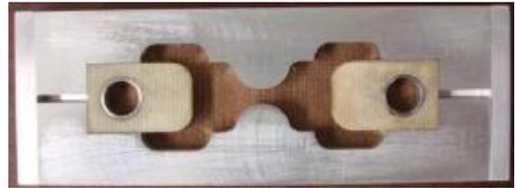
Figura 2 – Configuração final do molde com o corpo de prova
