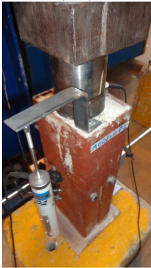
Figura 7 – Desenho esquemático de ensaios de cisalhamento em PMPC com conectores parafusos e rebites de rosca interna
