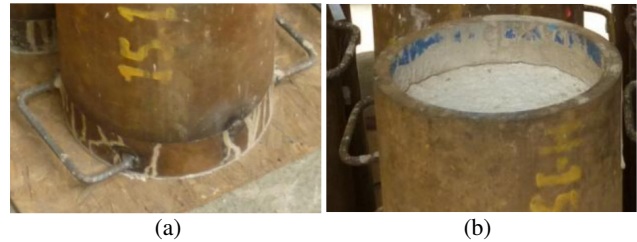
Figura 5 – Ensaio de cisalhamento em PMPC com conectores parafusos
