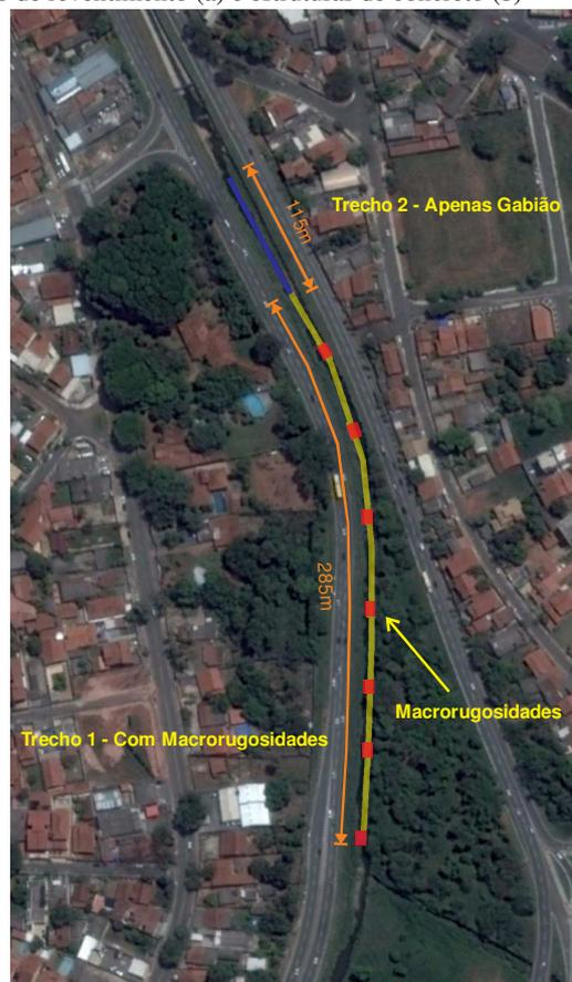
Figura 4 – Trecho do canal monitorado indicando o formato e tipo de revestimento (a) e estruturas de concreto (b)
