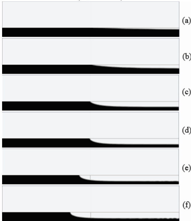
Figura 12 – Forma e posição da superfície livre para diferentes vazões de alimentação de líquido (em kg/s): (a) 0,016; (b) 0,012; (c) 0,008; (d) 0,007; (e) 0,0064; e (f) 0,006. Em todos os casos Ca = 2,006 e Re = 19,9
