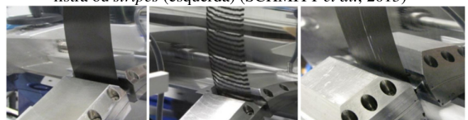
Figura 5 – Substrato revestido homogêneo (esquerda), com defeito tipo barramento ou barring (centro) e com defeito tipo listra ou stripes (esquerda) (SCHMITT et al. , 2013)
