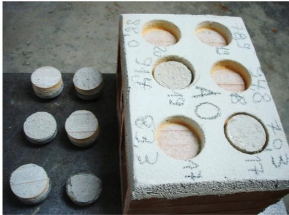
Figura 8 – Rupturas por arrancamento em blocos com argamassa AP10
