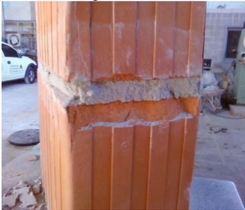
Na Tabela 8 são mostrados os resultados referentes às resistências à compressão dos prismas de alvenaria estrutural ( $f_{pm}$ ) para os diferentes tipos de argamassas modificadas, bem como o desvio padrão ( $Sd$ ) e coeficiente de variação ( $CV$ ).
