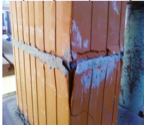
Figura 5 – Fendilhamento e rompimento do bloco em prisma com argamassa AP10
