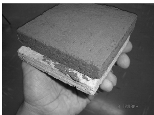
Figura 1 – Corpo de prova de concreto com agregado de RCD – solo após ter sido submetido ao ensaio de cisalhamento.
