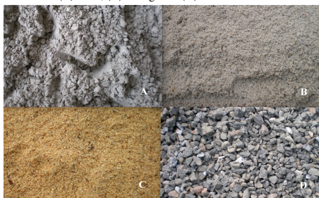
Figura 1 – Componentes dos concretos estudados: (A) cimento, (B) areia, (C) serragem e (D) brita.
