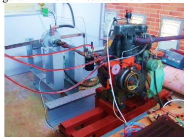
Figura 1 – Motor instalado no dinamômetro
