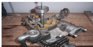
Figura 6 – Fixação do tubo de furo calibrado no cabeçote, com a base do cilindro hidráulico
