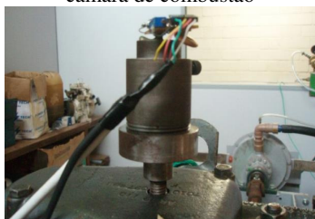
Figura 4 – Dispositivo condicionador de pressão do sensor da câmara de combustão
