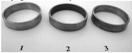
Figura 5 – Núcleos toroidais de Fe 50 Co (1), Fe 2 SiP (2) e Fe 3 Si (3), empregados na construção dos anéis de Rowland
