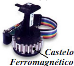
Figura 2 – Cabeçote Impressor Matricial (CIM). Fonte: Menno Equipamentos (2009)
