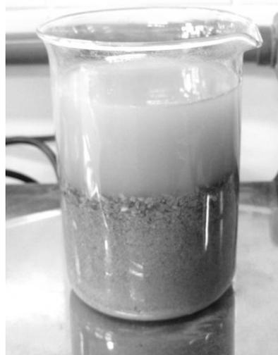
Figura 4-b. Teor de Material Pulverulento da Areia RCD.
