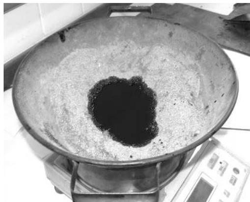
Figura 9. Pesagem do CAP na Mistura com Fibra do Açai
