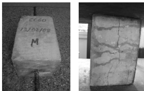
Figura 15. Ensayos monotónicos para concretos CC con barras de acero de 16mm.
