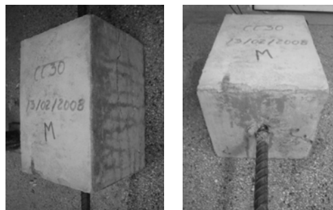
Figura 13. Ensayos monotónicos para concretos CC con barras de acero de 10mm.
