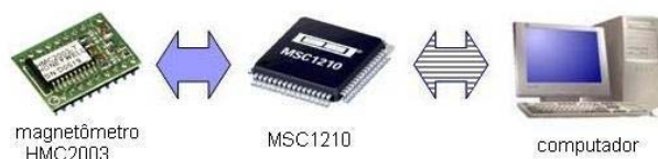
Figura 6: Esquema da conexão dos componentes da montagem para determinação de atitude utilizando o módulo MSC1210.
