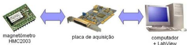
Figura 4: Esquema da conexão dos componentes da montagem para determinação de atitude utilizando o software LabView.
