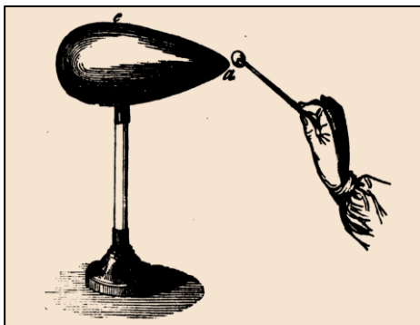
Figura 11: Elipsoide de metal para demonstrar a influência da forma dos corpos na acumulação da eletricidade.
