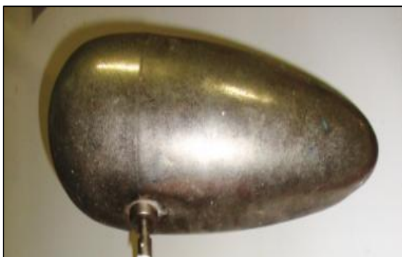
Figura 12: Elipsoide de metal para demonstrar a influência da forma dos corpos na acumulação da eletricidade (Não foi possível localizar neste equipamento a sua origem de fabricação).
