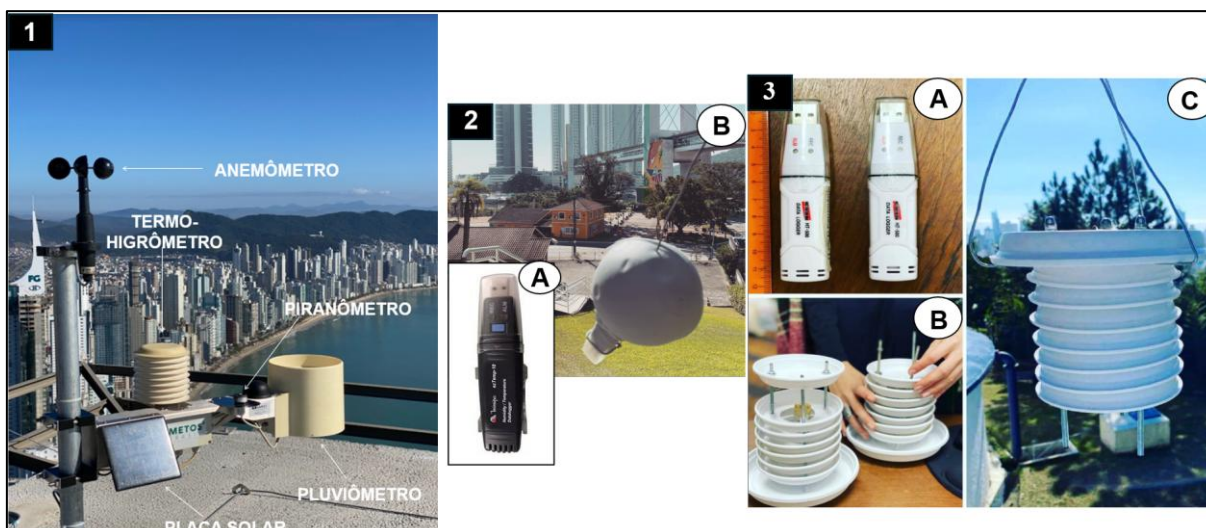
Figura 4 - [1] Estação Meteorológica Automática das Metos Brasil modelo iMETOS 3.3 - [2] Datalogger modelo HT 500 Instrutherm (A); Abrigo meteorológico de baixo custo em polipropileno: confecção (B); instalado para coleta (C) Abrigo Meteorológico - [3] Datalogger modelo HT 500 Instrutherm (A); Abrigo meteorológico de baixo custo de Polipropileno: Confecção (B); instalado para coleta (C)
