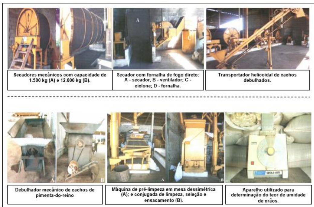
Figura 3 - Equipamentos utilizados na secagem, na limpeza e na pesagem da pimenta-do-reino do tipo preta, em grãos
