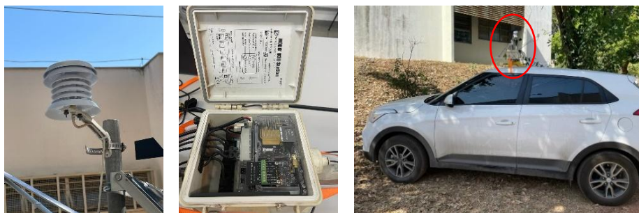
Figura 7 - Equipamentos de medição do transecto móvel
