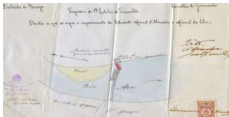
Figura 5. Planta relativa ao processo para abrir cinco comportas num açude-levada no rio Ave (Silvares, Guimarães, 1904).
