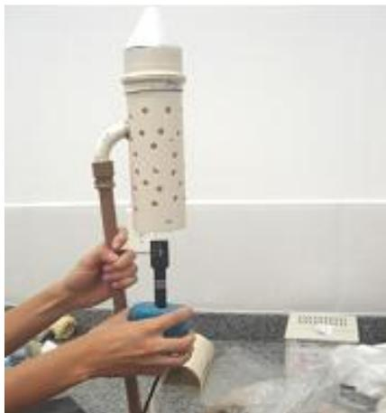
Figura 6 – Abrigo para termo-higrômetro
