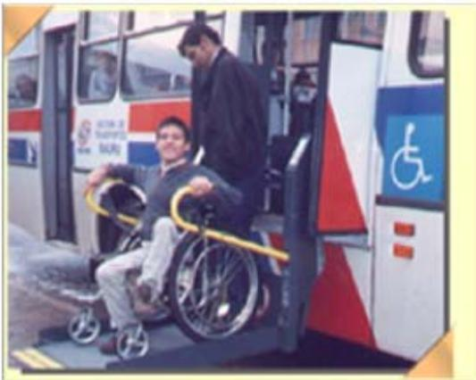
Figura 1: Ônibus com Plataforma Elevatória.
