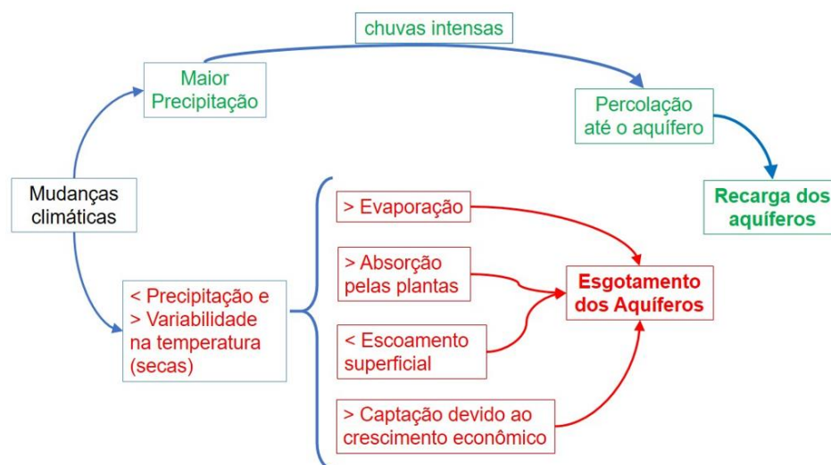
Figura 2: Esquema para a recarga de aquíferos. Em azul, situação de maior precipitação; em vermelho, situação das estiagens e secas
