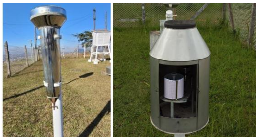
Figura 2: Pluviômetro e pluviógrafo utilizado em estações convencionais do INMET
