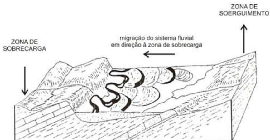
Figura 6 – Modelo de migração fluvial associada à compensação isostática em zonas de sobrecarga. Modificado de Holbrook; Schumm (1999).
