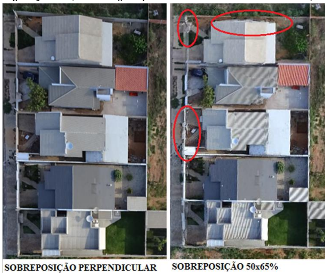
Figura 5. Distorções em imagens apontadas em coberturas e muros de edificações.
