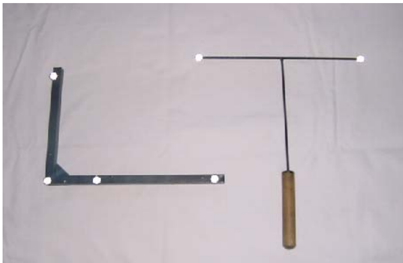
Figura 2. Estrutura em “L”, representando o sistema de coordenadas utilizadas neste estudo e o bastão em “T”, chamado de corpo de prova, usado para a calibração do volume.
