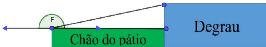
Figura 9 – Medição do ângulo de inclinação com a unidade de medida F
