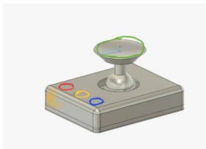
Figura 2 - Mouse adaptado para pessoas com mobilidade reduzida
