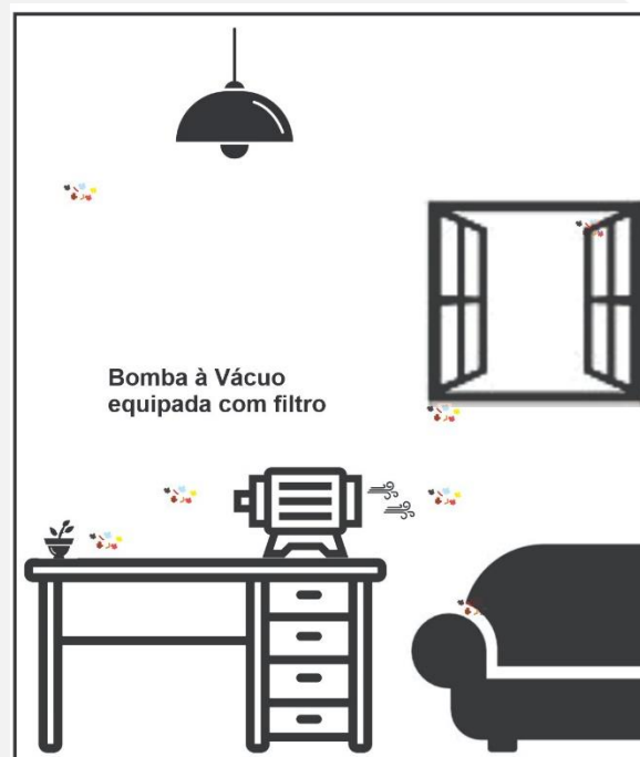
Figura 7 –Amostragem ativa em ambiente interno
