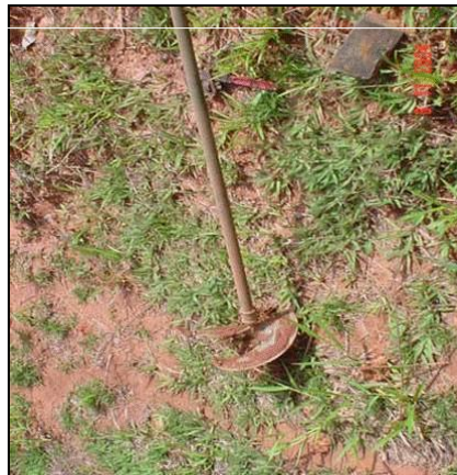
Figura 6 - Trado tipo helicoidal utilizado na perfuração manual
